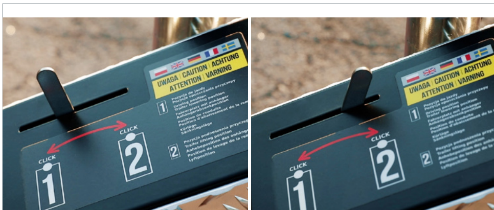
Zahngetriebe: POSITION 1 - Fahren / Absenken, POSITION 2 - Heben
